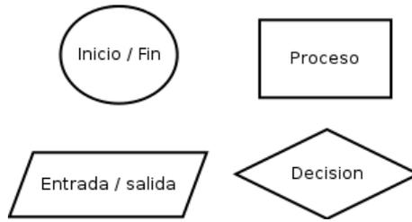
El inicio o el final del programa se indica dentro de un círculo. Los procesos internos, como realizar operaciones, se encuadran en un rectángulo. Las entradas y salidas (escrituras en pantalla y lecturas de teclado) se indican con un paralelogramo que tenga su lados superior e inferior horizontales, pero no tenga verticales los otros dos. Las decisiones se indican dentro de un rombo.
