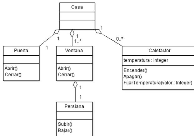
Este diagrama es una forma más simple de ver las clases existentes y las relaciones entre ellas. Si generamos las clases a partir del diagrama, tendremos parte del trabajo hecho: ya "sólo" nos quedará rellenar los detalles de métodos como "Abrir", pero el esqueleto de todas las clases ya estará "escrito" para nosotros.
